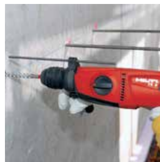
เหมาะสำหรับงานเจาะรูในคอนกรีต และงานอิฐ ทั้งงานพื้นและผนัง
