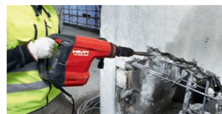
TE 800-AVR สกัดช่องเปิดผนังคอนกรีตได้ง่ายขึ้นด้วยด้ามจับที่ใหญ่ นิ่ม จับถนัดมือ
